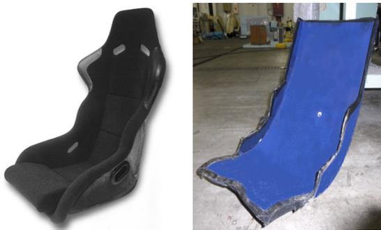
図 46 フルバケットシート 図 47 製作したシート
