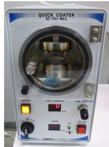
図 2.30 (a)試料加工用乾式ダイヤモンドワイヤーソー及び(b)銀蒸着用スパッタ装置の外観図。
