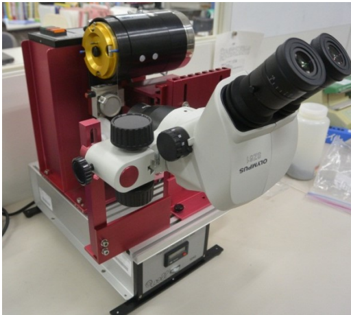
図 2.30 (a)試料加工用乾式ダイヤモンドワイヤーソー及び(b)銀蒸着用スパッタ装置の外観図。
