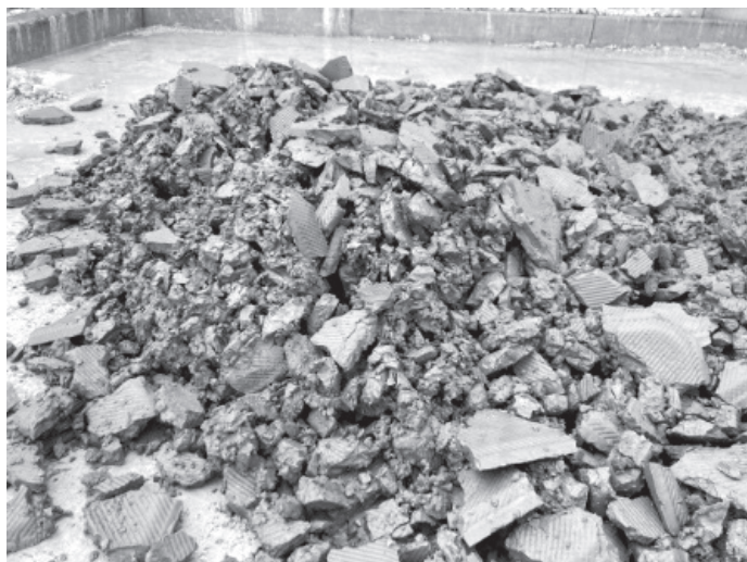
図6 フィルタープレスで固液分離した固形分
