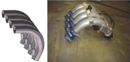
図10 インテークマニホールドのCAD図と完成品
