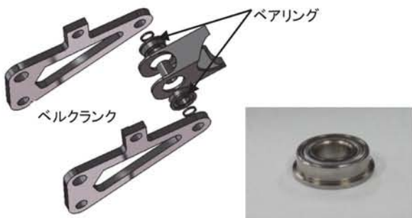
図38 ベルクランク構成と使用したベアリング
