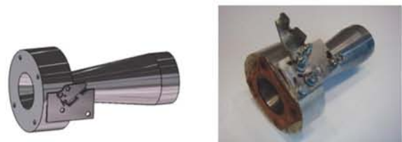
図 8 リストリクタの CAD 図と完成品
