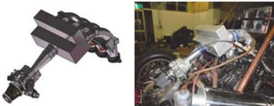
図11 吸気系 Assy のCAD図と完成品
