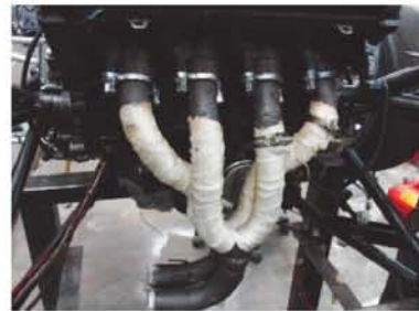
図 16 車載した排気管
