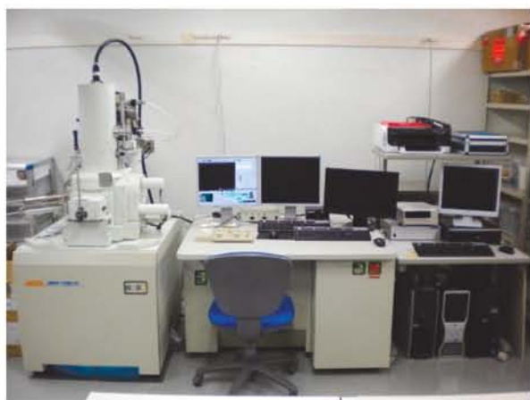
図1 電界放出形走査型電子顕微鏡装置の外観
