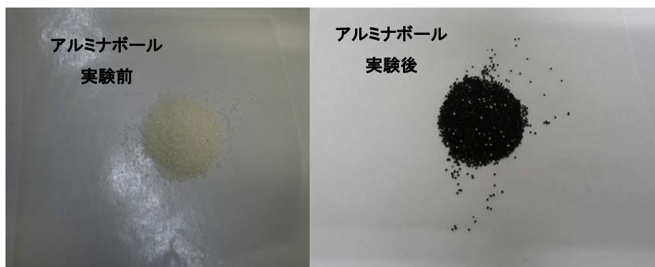
Figure II. 8 アルミナボール状態：左→実験前、右→実験後
