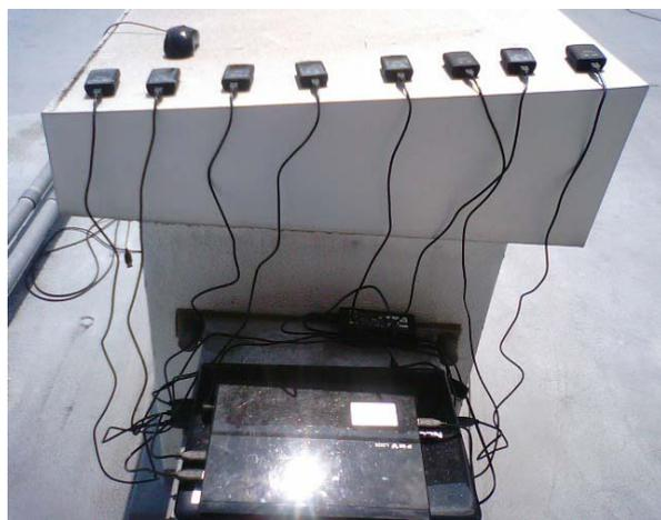
図 9. 複数 GPS 端末を用いた GPS 群特性の測定模様
