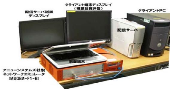
図4 アニューシステム社製ネットワークエミュレータ(MSGEM-F1-B)を用いた評価システム構成
