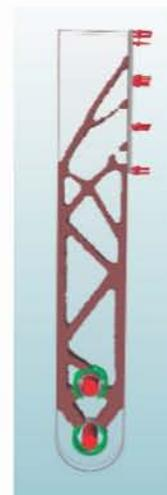
図12 クラッチ、ブレーキペダル最適化結果
