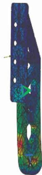
図13 アクセルペダル解析結果
